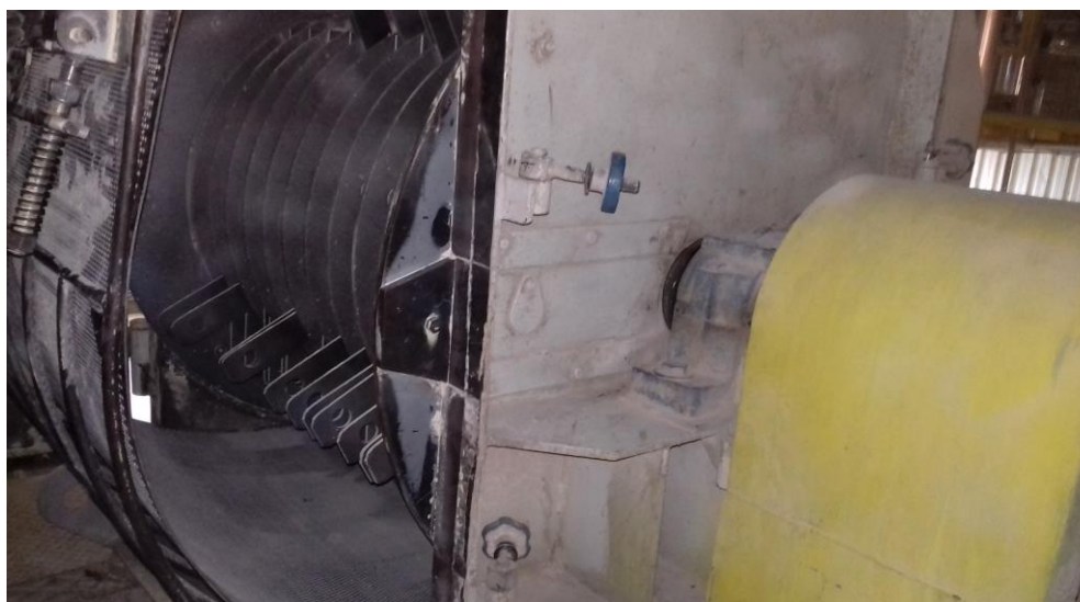
FIGURA 7 – Retirada dos eixos e martelos
