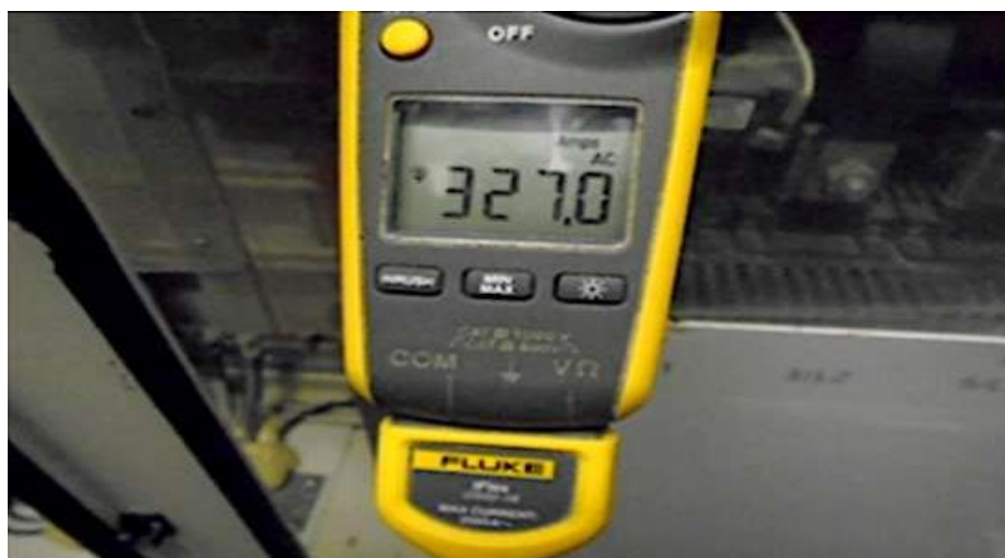
FIGURA 5 – Corrente do motor sem carga
